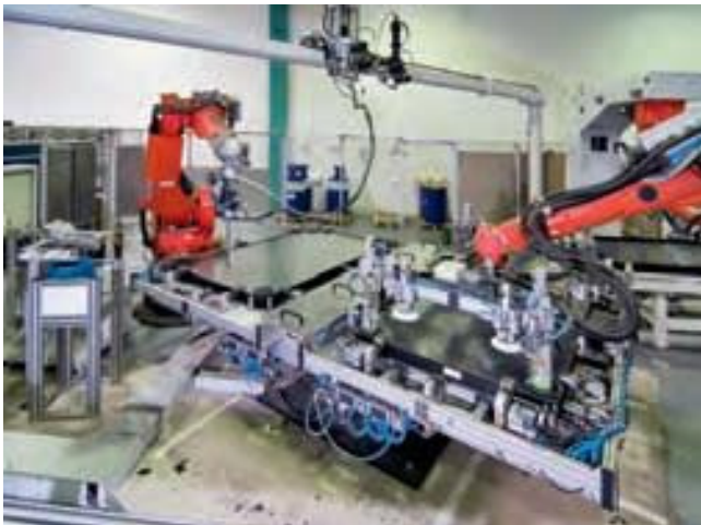
Roboter aus der Autoindustrie: Nach dem Boomjahr 2008 investierten wie Vaillant viele Thermie-Hersteller in die Modernisierung ihrer Kollektorproduktion. Die Automatisierung hat allerdings ihre Grenzen.
