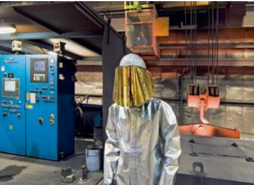
Mars-Mission: Spezialanzüge schützen die Arbeiter vor der Abwärme des geschmolzenen, rund 1400 Grad heißen Eisens.
