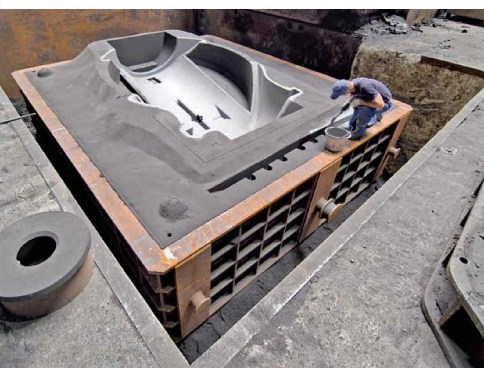
Handarbeit: Die Negativform eines Maschinenträgers wird in der Gussmulde für den Einsatz vorbereitet.
