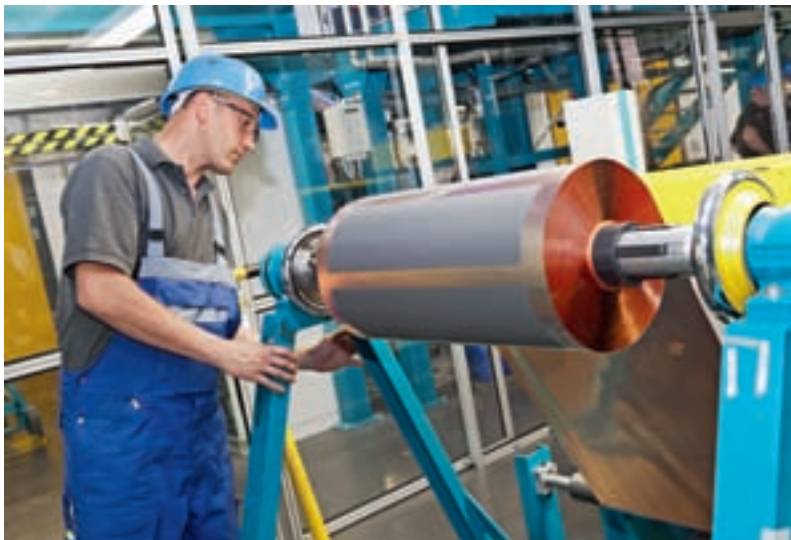
Schnittmuster: Die Chemikalien-Mischung für die Elektroden wird auf Metall-Folien gesprüht, getrocknet und ausgeschnitten.
