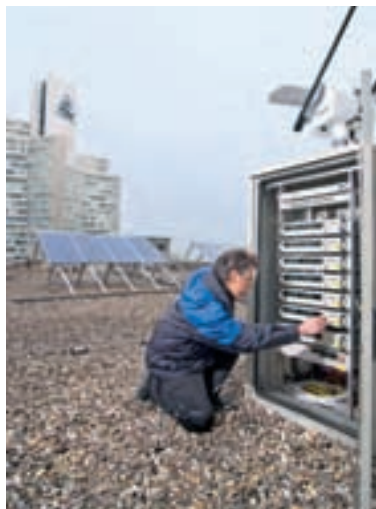
Leistungsvergleich: Ein Jahr lang hat der TÜV-Rheinland Erträge von Solarmodulen gemessen.
