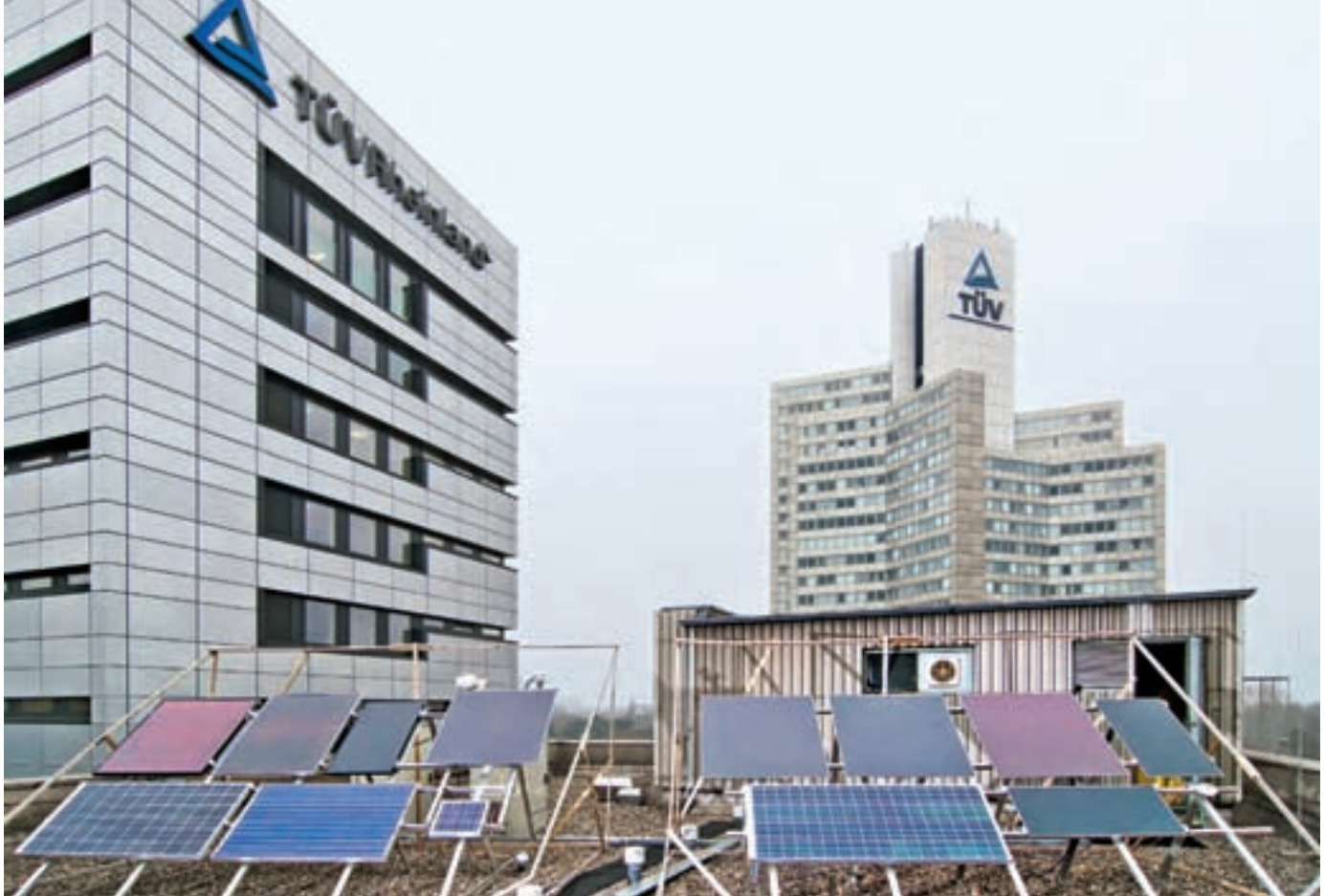
Auf die Plätze, fertig, ...Strahlen sammeln: Module verschiedener Halbleiter-Technologien auf dem Testfeld des TÜV-Rheinland.
