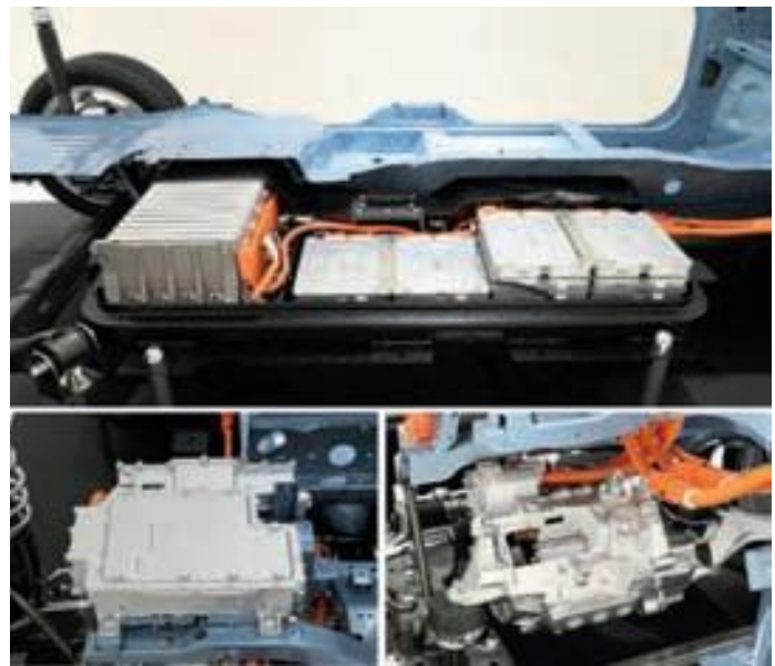
Speicher und Stabilität: Das Batteriepaket des Leaf ist platzsparend und flach in den Unterboden integriert.
