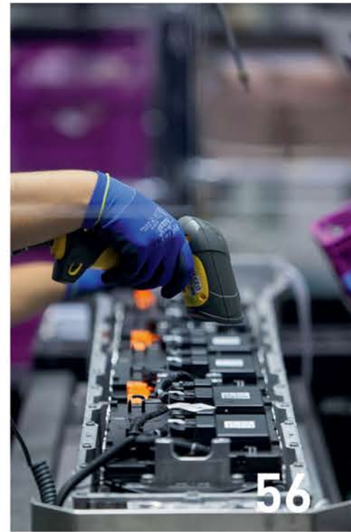
Herzstück: Lithium-Ionen-Batterien für Elektroautos.
