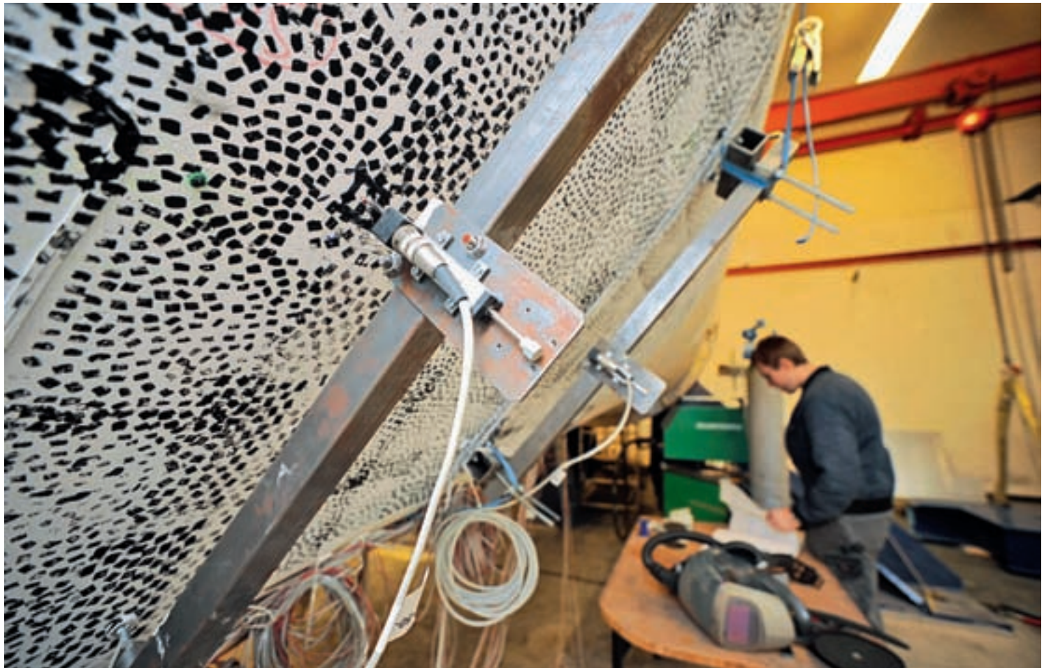
Feinfühlig: Sensoren lassen keine Handbreit aus beim Abtasten der Großkomponente. Es geht um Materialsparen: Von Biegekräften bedrohte Stellen sollen exakt verstärkt, anderswo wird die Flügelhaut dünner.
